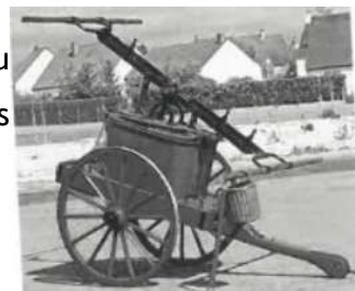
Les pompes à bras sont utilisées jusqu'au début du XXème siècle. Elles sont ensuite remplacées par les pompes à moteurs ou motopompes.
